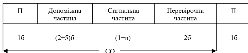
Рисунок 28 – Структура СО системи сигналізації ЗКС №7
