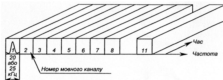
Рисунок 7.21 – Принцип множинного доступу до радіоканалів з частотним розподілом
