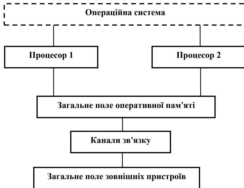
Рис. 6.16. Схема взаємодії процесорів в ОС
