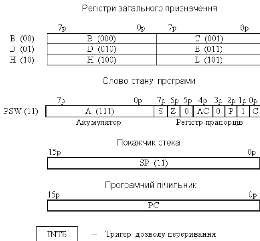
Рисунок 4.1 – Програмна (програмістська) модель МП i8080
