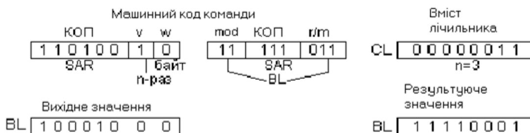
Рисунок 8.1 – Приклад використання команди SAR при n=3
