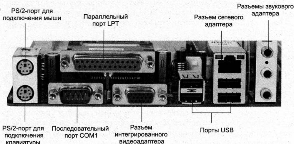
Рис. 1.7. Разъемы на задней панели системной платы
