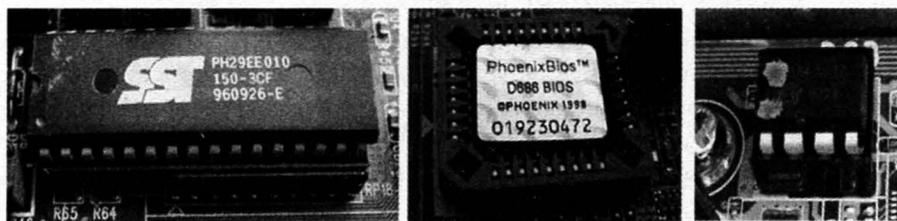
Рис. 2.1. Примеры установки микросхемы BIOS в панель на системной плате
