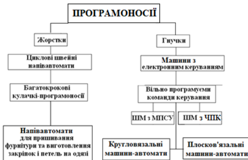
Рис. 2.3. Класифікація програмоносіїв механіко-технологічних систем на прикладі технологічних машин легкої промисловості
