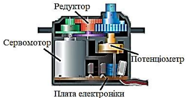
Рис. 4.25. Монтажна схема (а) з макетною платою та двома сервоприводами SG90 (б) з вбудованим редуктором і потенціометром зворотного зв'язку прямого ручного керування за допомогою
