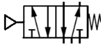
Рис. 1.10. Умовне позначення на схемах типу ПЗ пневмоозподільника п'яти лінійного двопозиційний (тип 5/2) з електромагнітним Бістабільним керуванням
