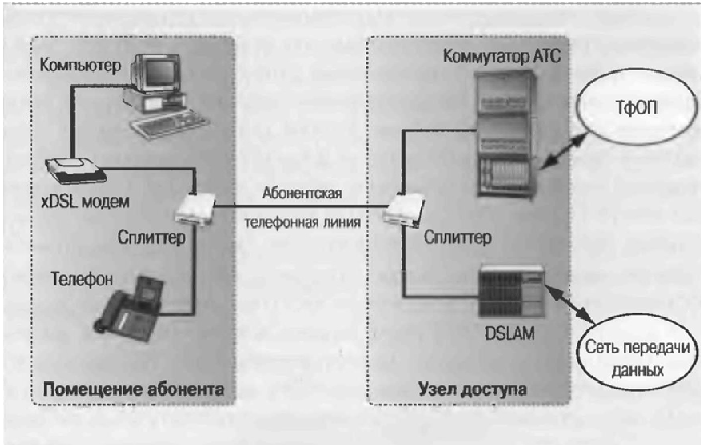
Рис. 21. Структура мережі доступу, побудованої за технологією xDSL
