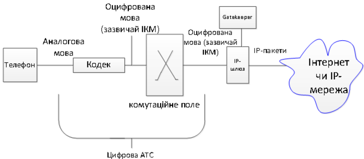
Рисунок 2.3 – Положення шлюзу в мережі IP-телефонії
