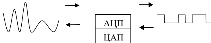
Рисунок 2.82. Процес перетворення неперервного (аналогового) звукового сигналу у цифровий двійковий код
