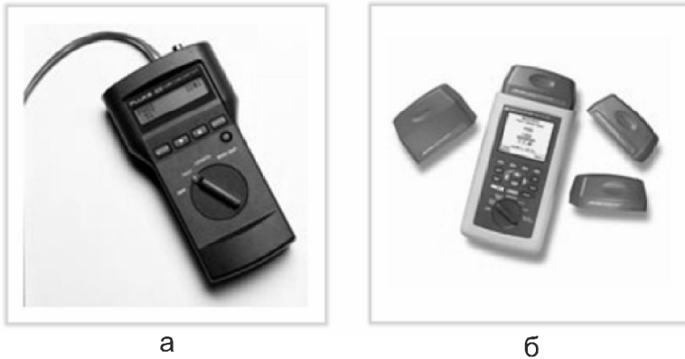
Рис. 2.8. Кабельний тестер (а) та кабельний сертифікатор (б)
