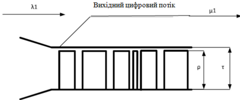
Рисунок 4.15 - Схематичне представлення цифрового потоку у каналі зв'язку
