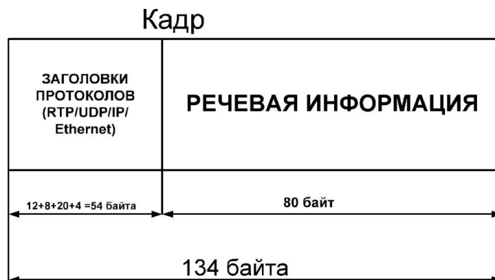
Рисунок 4.12 - Формат кадру G.711, що передається по IP мережі
