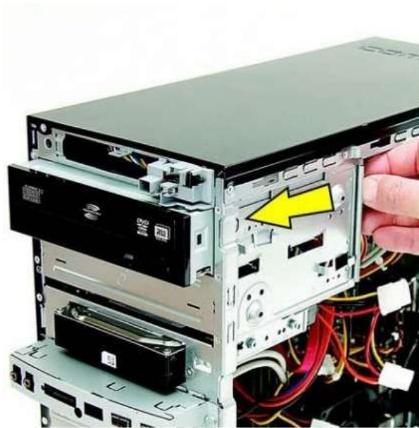
Рисунок 3.20. Процедура встановлення оптичного привода
