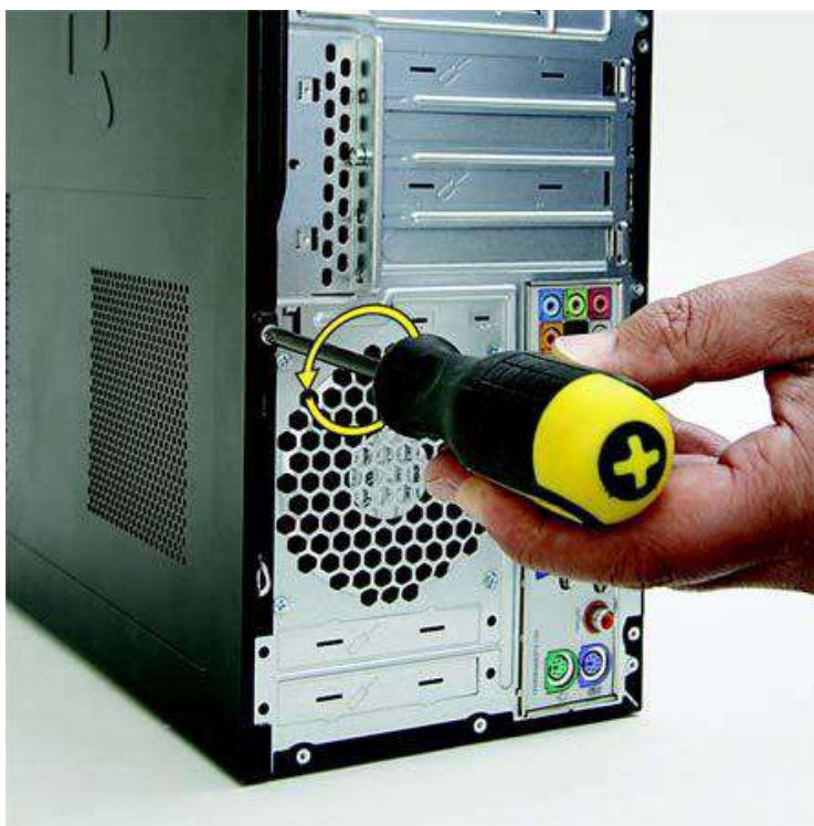
Рисунок 2.7. Відкриття системного блоку
