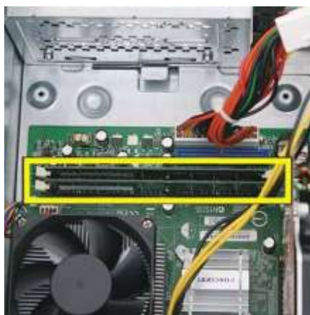
Рисунок 2.11. Встановлення модуля пам'яті
