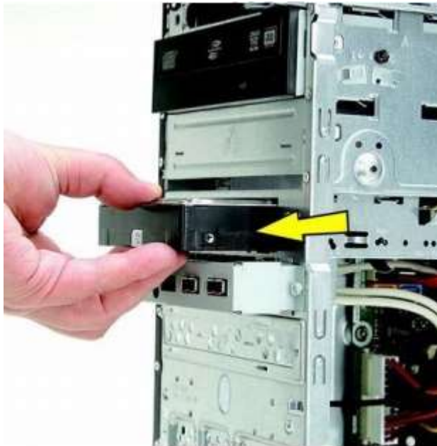
Рисунок 3.7. Вилучення внутрішнього жорсткого диска
