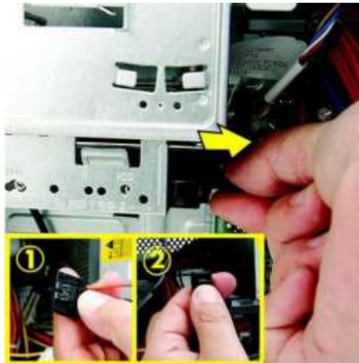
Рисунок 3.6. Процедура від'єднання кабелів живлення та передачі даних
