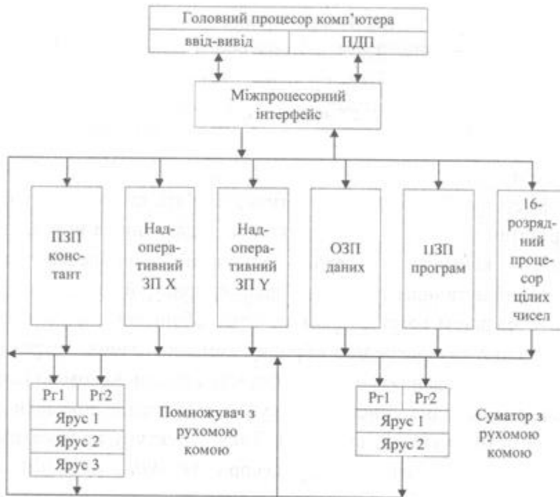
Рисунок 4.10. – Структура процесора AP-120B
