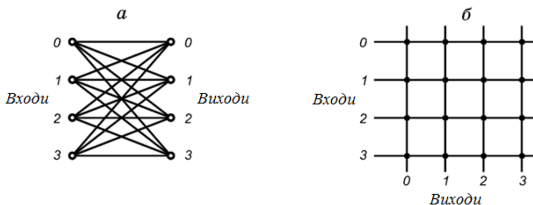
Рисунок 4.23. – Два подання координатного перемикача розміром 4×4: а – у вигляді дводольного графа; б – у вигляді решітки зв'язків
