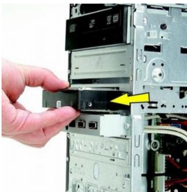
Рис.3.7. Вилучення внутрішнього жорсткого диска
