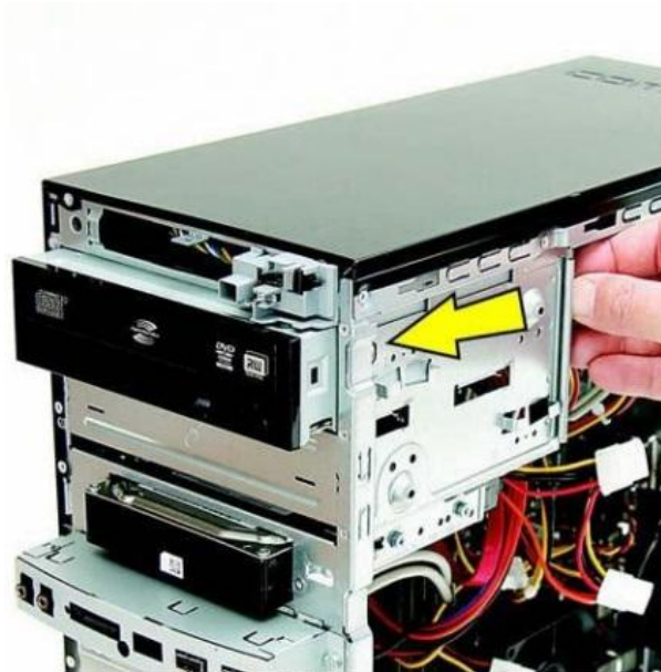
Рис. 3.20. Процедура встановлення оптичного привода
