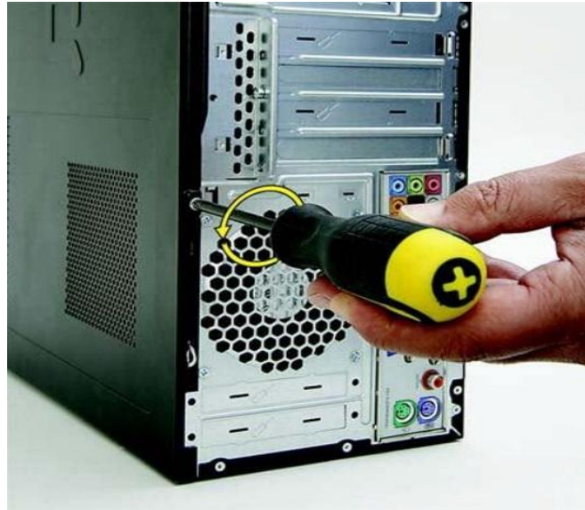
Рис.3.3. Розкручування задньої панелі
