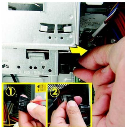
Рис. 3.6. Процедура від'єднання кабелів живлення та передачі даних
