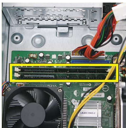
Рис. 2.11. Встановлення модуля пам'яті
