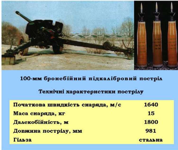
Рис. 9.6.3. Підкалібровий постріл для 100-мм протитанкової гармати МТ-12
