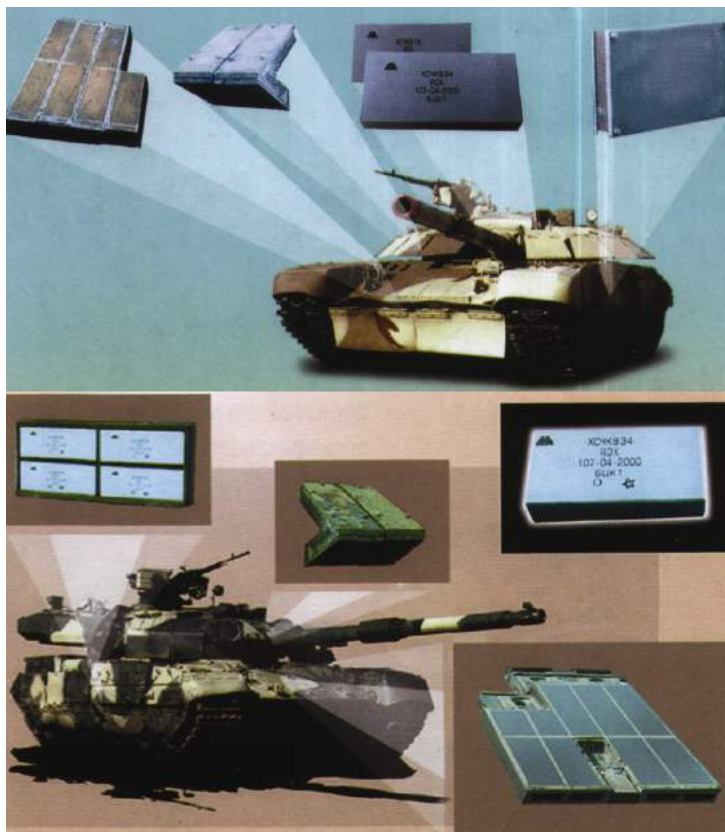
Рис. 2.2.15. Варіант розміщення додаткових засобів захисту на танках Т-72, Т-80 (ходова частина танку на половину прикривається "спідницею" з бокових металевих плит)
