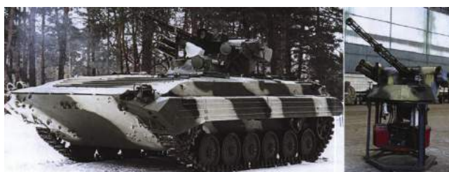
Рис. 2.2.3. Модернізований варіант бойової машини піхоти БМП-2М з баштовим модулем "Шквал"
