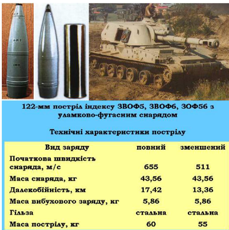
Рис. 9.6.2. Уламково-фугасний постріл для самохідної гаубиці 2С3 "Акація"
