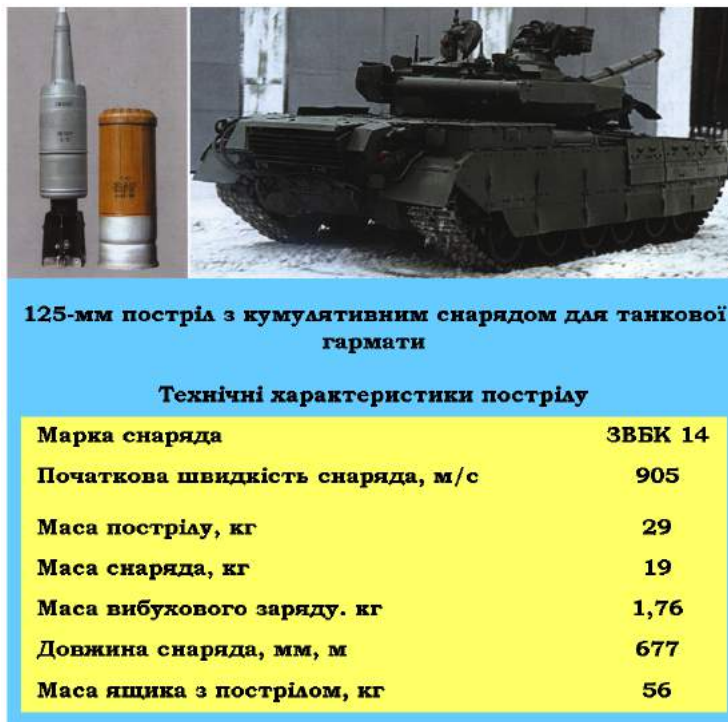
Рис. 9.6.5. Кумулятивний постріл для 125-мм танкової гармати
