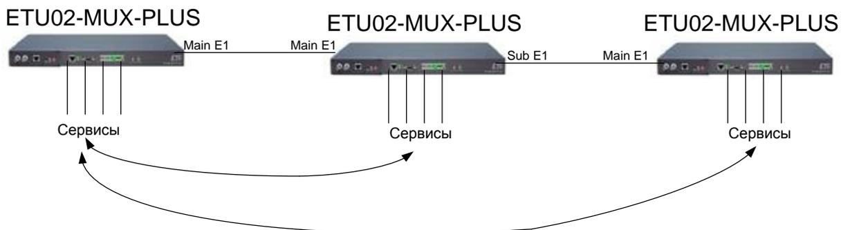
Рисунок 4.2 Варианты топологии «последовательная цепь»
