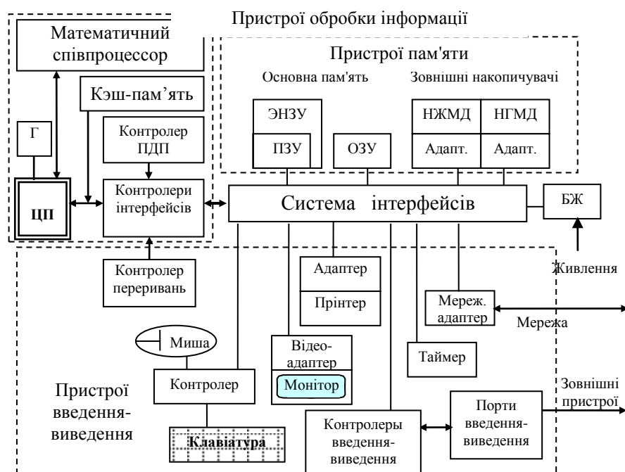
Рис. 13. Узагальнена базова функціональна схема комп'ютера
