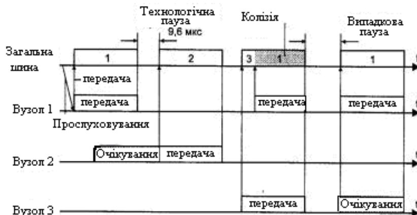
Рис. 3.4. Метод випадкового доступу CSMA/CD
