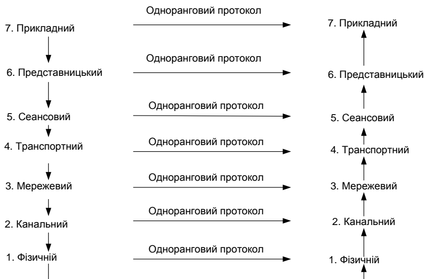
Рис. 1.14. Передача пакетів інформації по рівням
