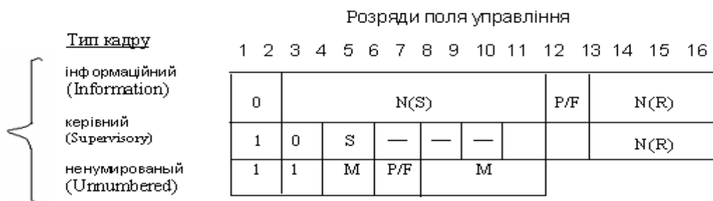
Рис. 3.3. Структура поля керування
