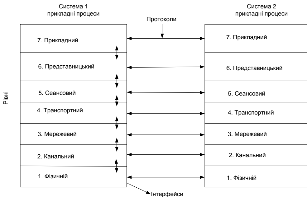
Рис. 1.12. Модель взаємодії відкритих систем ISO/OSI
