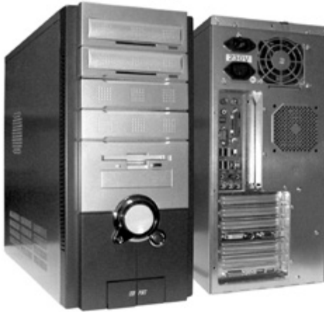
Рис.4 Системний блок ПК (передня та задня панель)
