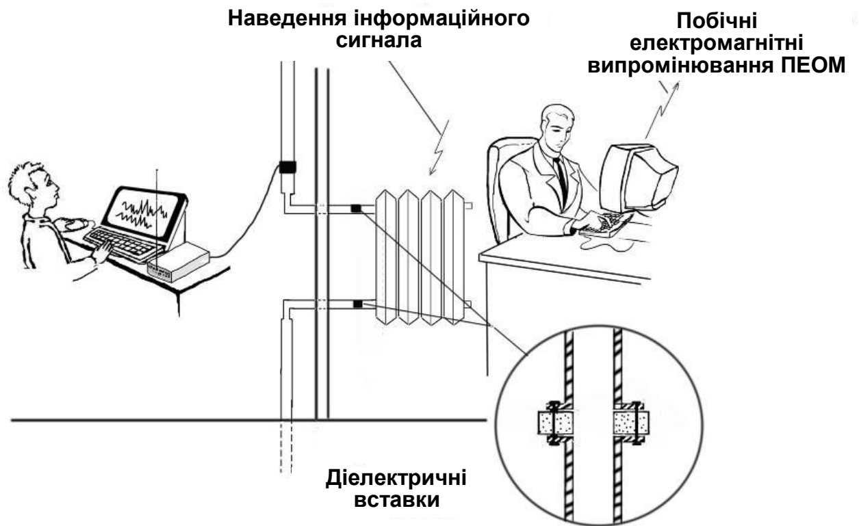
Рис. 2.7. Установка спеціальних діелектричних вставок
