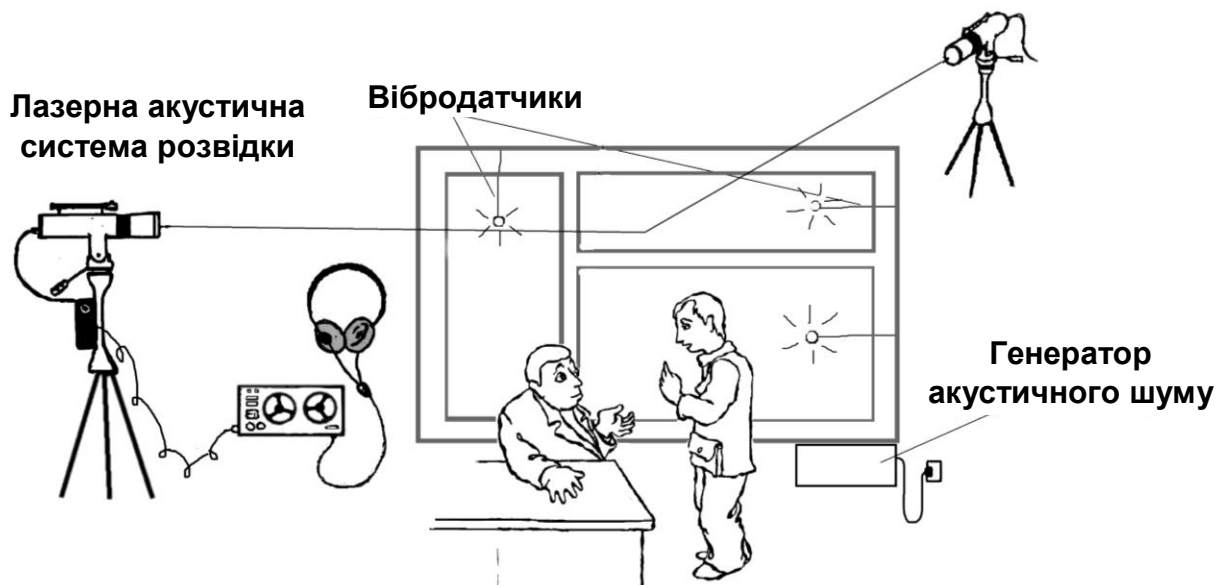
Рис. 2.12. Створення віброакустичних завад лазерній системі розвідки
