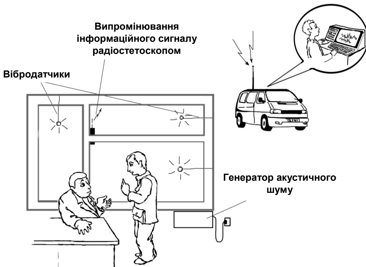
Рис. 2.13. Створення віброакустичних завад радіосигналу
