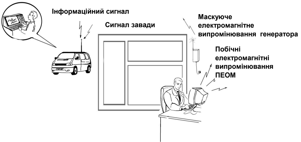
Рис. 2.10. Просторове електромагнітне зашумлення комп'ютерного місця
