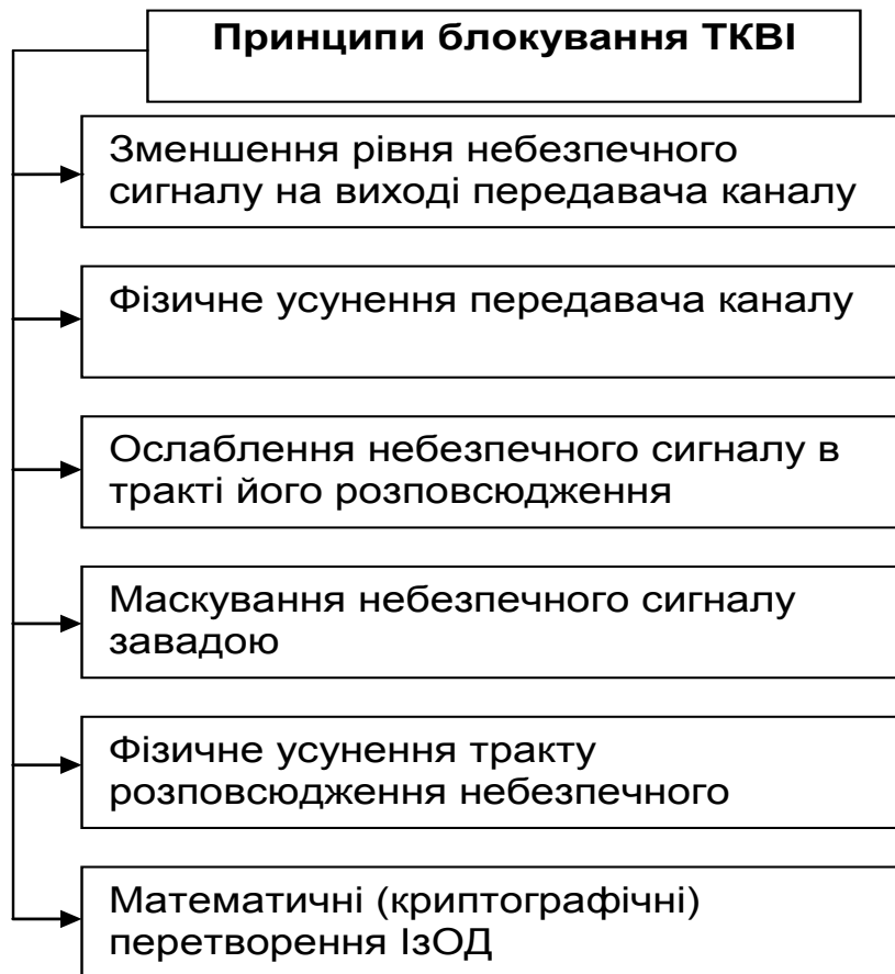
Рис. 2.4. Принципи блокування ТКВІ
