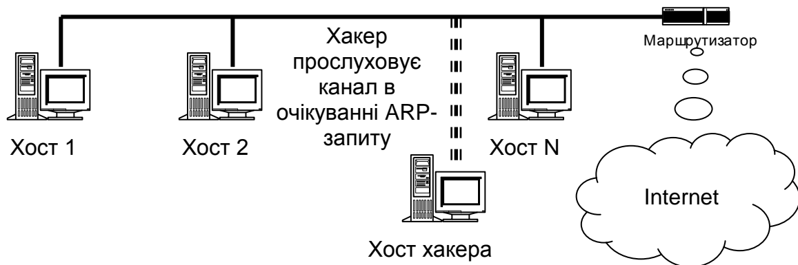
Рис. 1.22. Підставний ARP-сервер. Фаза очікування ARP-запиту
