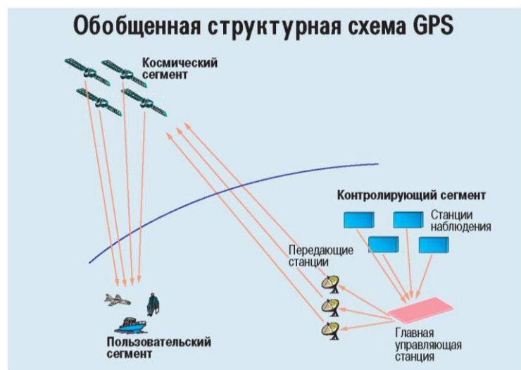
Рисунок 5.3 - Структурна схема системи GPS
