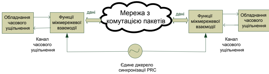
Рисунок 2.3 – Синхронізація від єдиного опорного джерела
