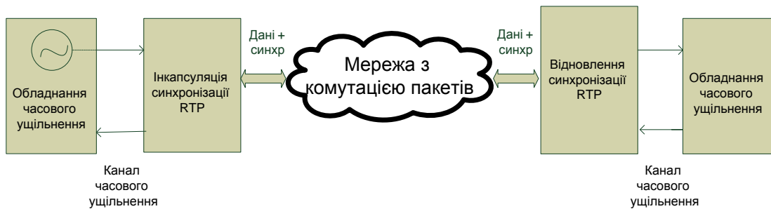
Рисунок 2.6 – Передача синхронізації за допомогою RTP
