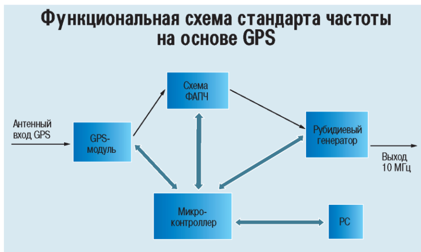
Рисунок 5.4 - Функціональна схема стандарту частоти на основі GPS
