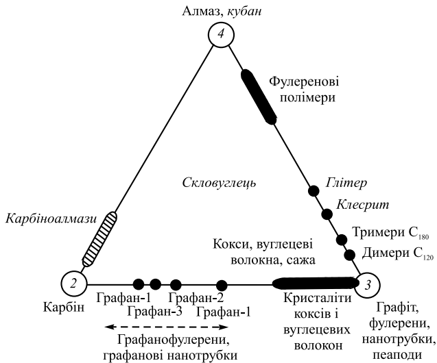
Рис. 9.3. Схема структурної класифікації вуглецевих матеріалів за кількістю сусідніх атомів в першій координаційній сфері або за співвідношенням атомів, що створюють в матеріалі 2, 3 або 4 ковалентні зв'язки (курсив – гіпотетичні структури)
