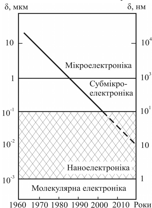
Рис. 4.13. Зниження з роками максимального розміру елементів інтегральної схеми
