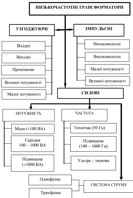
Рис. 8.10. Класифікація низькочастотних трансформаторів
