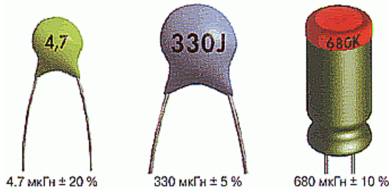
Рис. 8.13. Другий вид кодування котушок індуктивності
