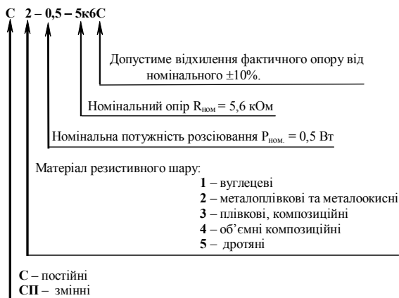
Рис. 6.24. Скорочене умовне позначення резисторів
