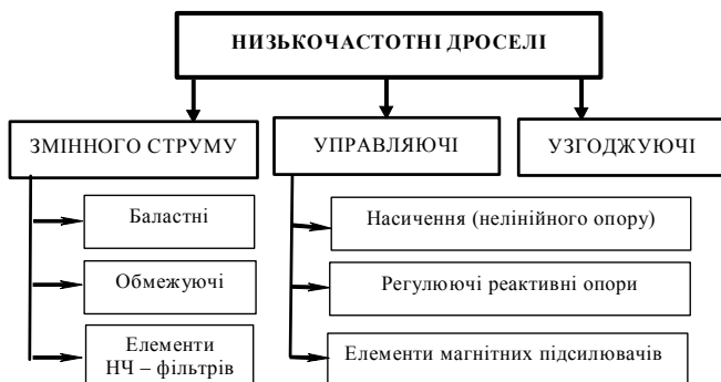
Рис. 8.11. Класифікація низькочастотних дроселів
