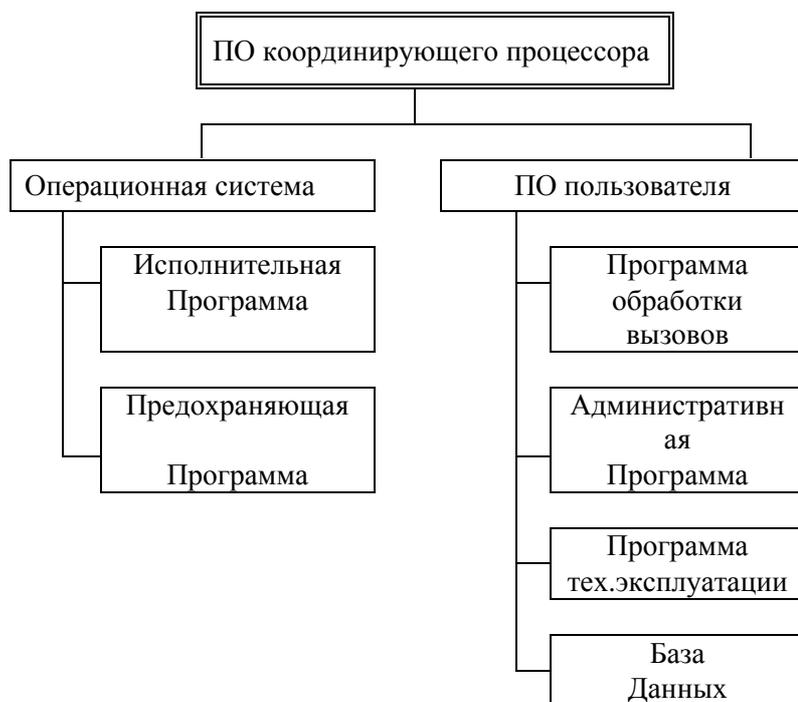
Рис.3.10. Архитектура программного обеспечения СР
