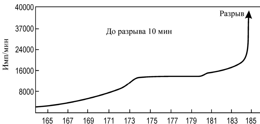
Рис. 2.19. Изменение скорости акустической эмиссии перед разрывом стальной трубы
