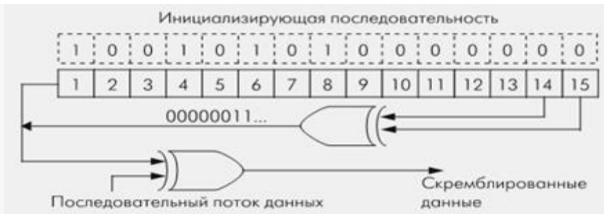
Рисунок 3 – Схема кодирования надточным кодом
