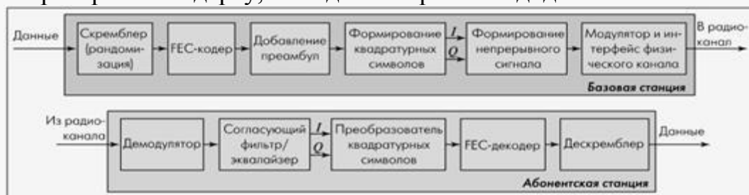
Рисунок 2 – Тракт формування вихідного сигналу в стандарті IEEE 802.16
