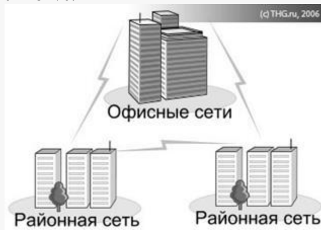
Рисунок 15 – Режим Fixed WiMAX
