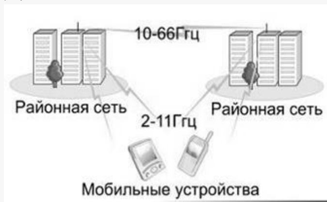
Рисунок 16 – Режим Mobile WiMAX
