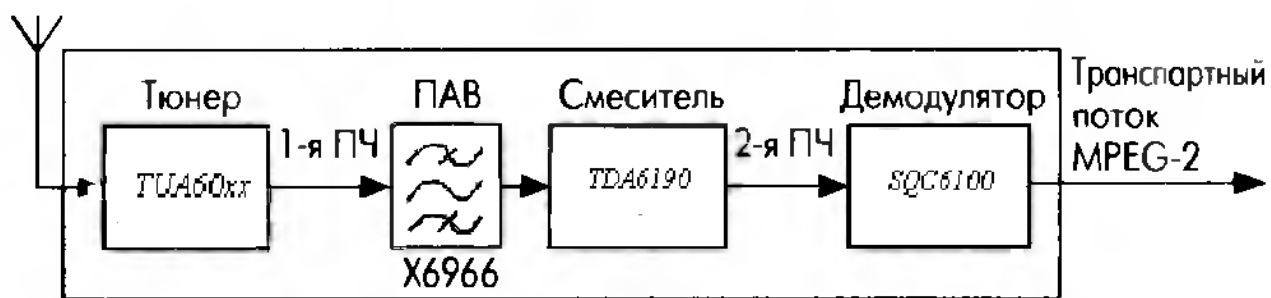
Рисунок 4.9 – DVB-T-приемник на базе ресивера SQC 6100
