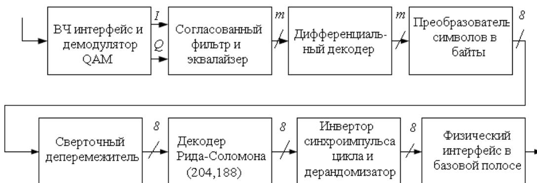
Рисунок 9.3 – Функциональная схема приемника - декодера кабельной системы стандарта DVB-C
