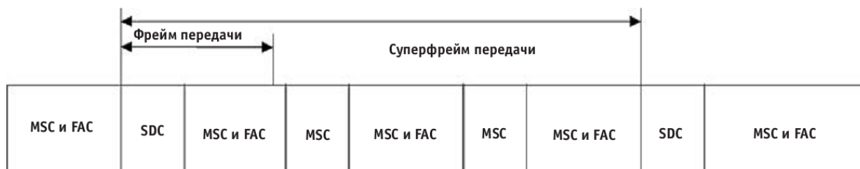
Рис.6. Временное размещение информации каналов MSC, FAC и SDC в суперфрейме передачи
