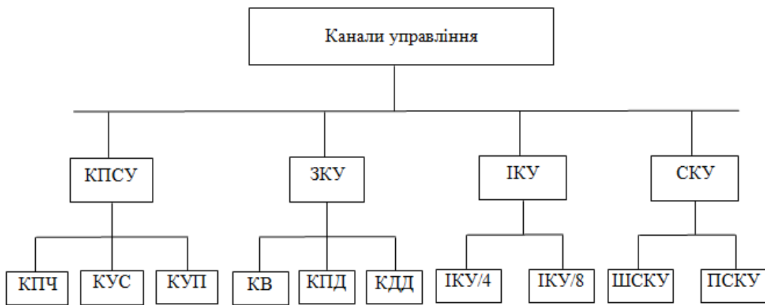
Рис. 4.1. Види логічних каналів управління в стандарті GSM
