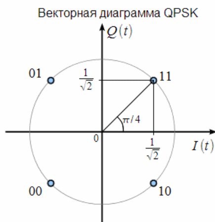
Рис. 9. Векторная диаграмма QPSK сигналов
