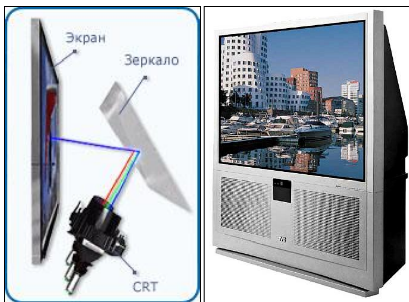
Рис. 18. Формирование изображения в проекционном кинескопном телевизоре и пример проекционного кинескопного телевизора
