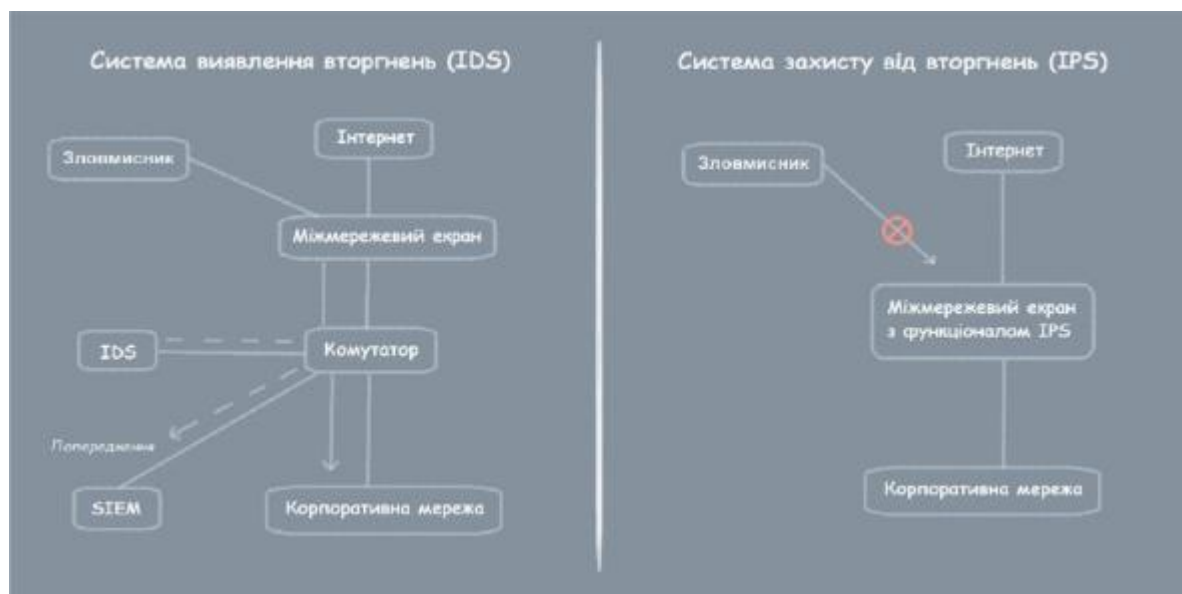
Рис. 1.10. Різниця між встановленням IDS та IPS систем
