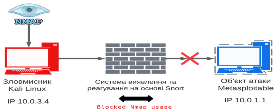
Рис. 3.17. Схема блокування пакету nmap
