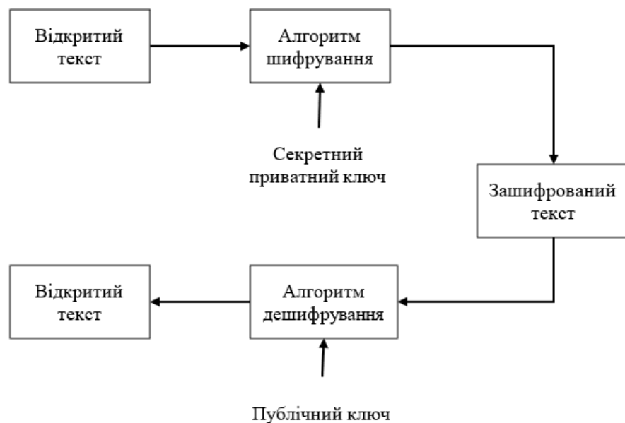
Рис. 2.4. Принцип асиметричного шифрування
