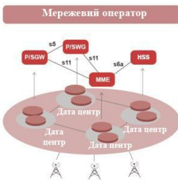
Рисунок 2.2. Приклад організації логічних ресурсів при віртуалізації базової мобільної мережі
