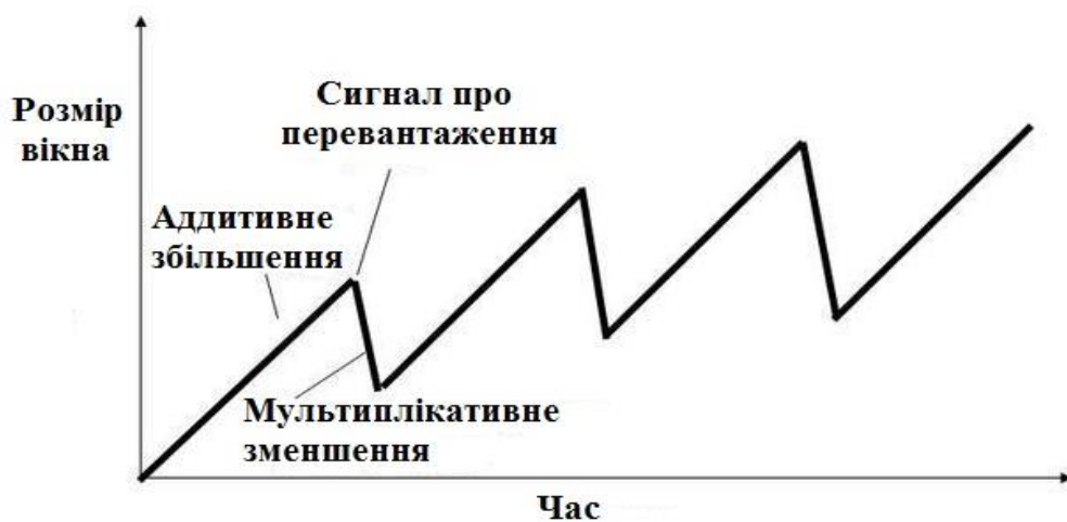
Рисунок 2.8. Алгоритм адитивного збільшення / мультиплікативного зменшення
