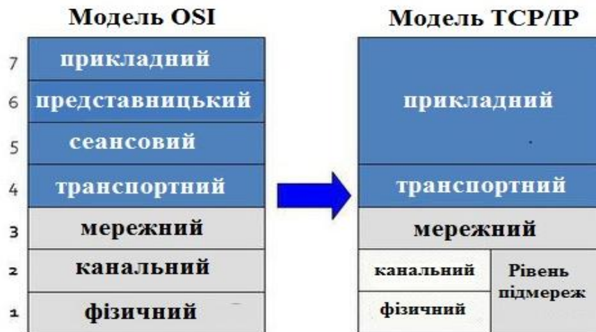
Рисунок 2.1. Відповідність еталонних моделей OSI та TCP/IP
