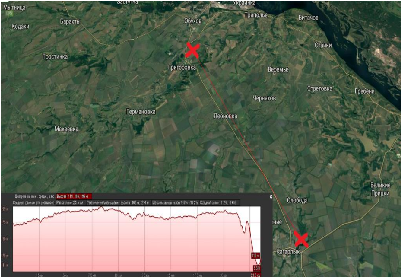
Рисунок 3.9. Рельєф прямої видимості нашої точки на базову станцію 4G LTE
