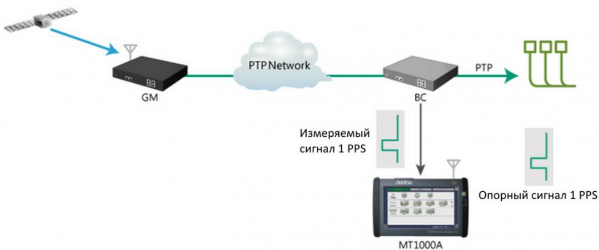
Рисунок 2.15. Вимірювання фазової помилки між вимірюваним та опорним сигналом 1 pps
