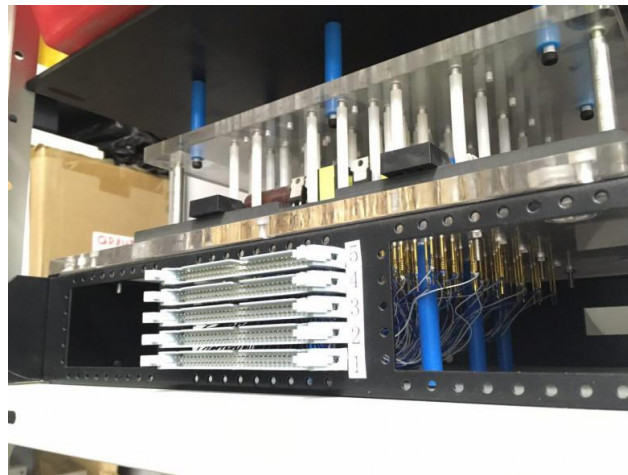
Рисунок 1.10 - Тестування друкованої плати за допомогою «Flying grid»
