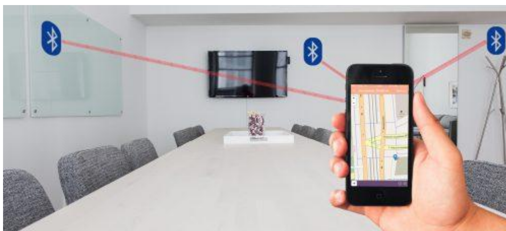
Рисунок 2.2 – Триангуляція за допомогою Bluetooth-маячків
