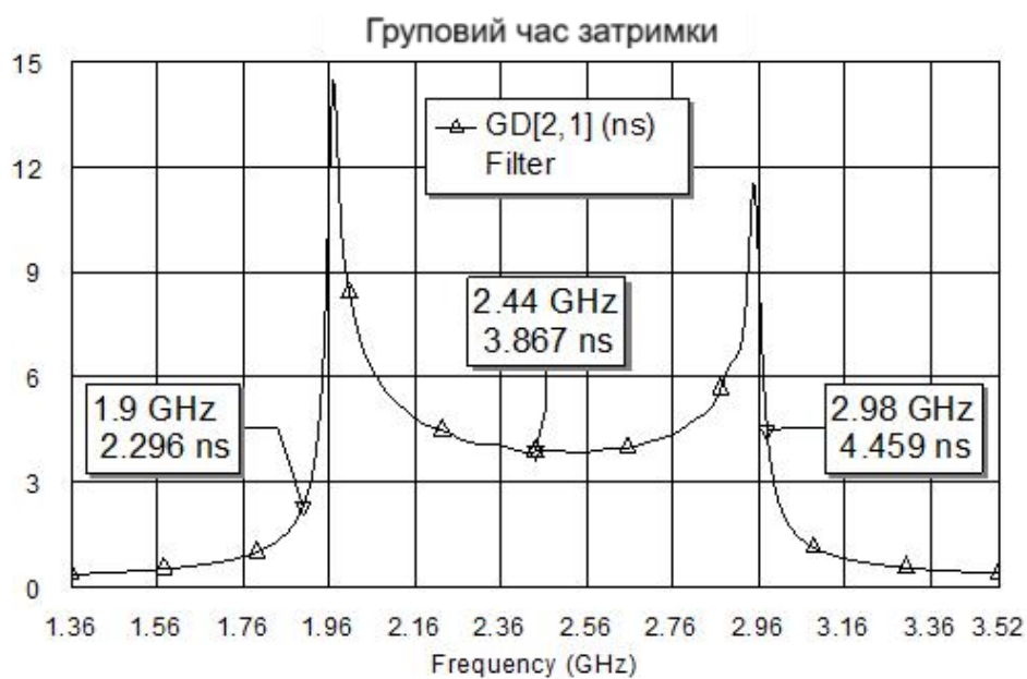
Рисунок 3.19 – Час затримки проходження сигналу через фільтр
