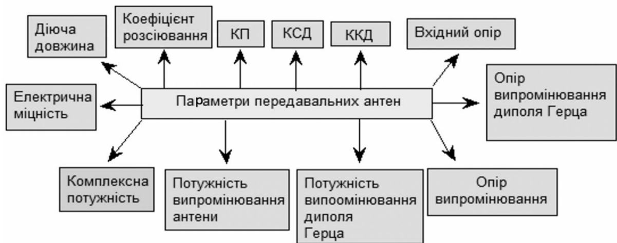
Рисунок 1.9 — Параметри передавальних антен
