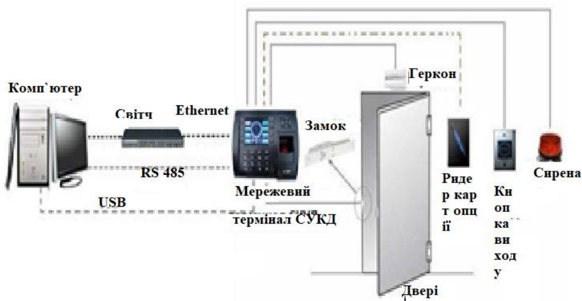
Рисунок 3.7. Схема мережевого біометричного терміналу
