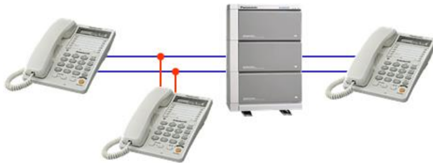
Рисунок 1.7. Схема підключення до телефонної лінії зв'язку.
