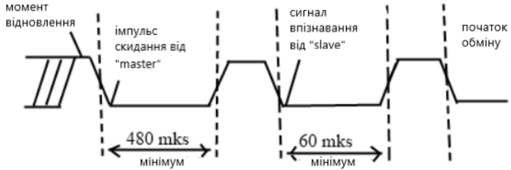
Рисунок 8. Передача даних по однопровідній двонаправленій лінії.
