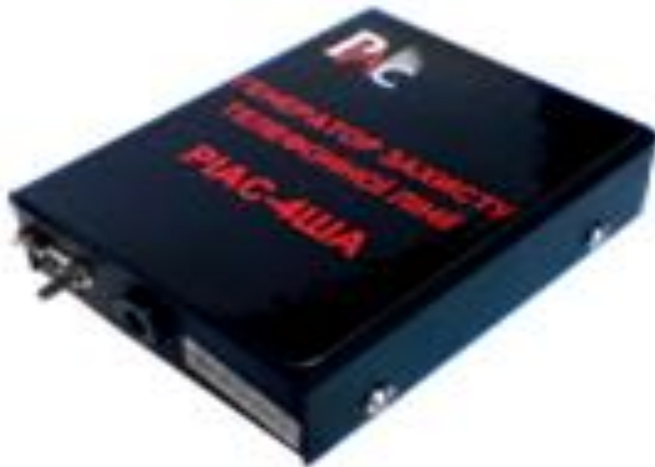
Рисунок 1.23. Генератор імітації шуму в мовному частотному діапазоні в режимі очікування виклику телефонного апарату в лініях аналогового телефонного зв'язку "РІАС-4ЩА".
