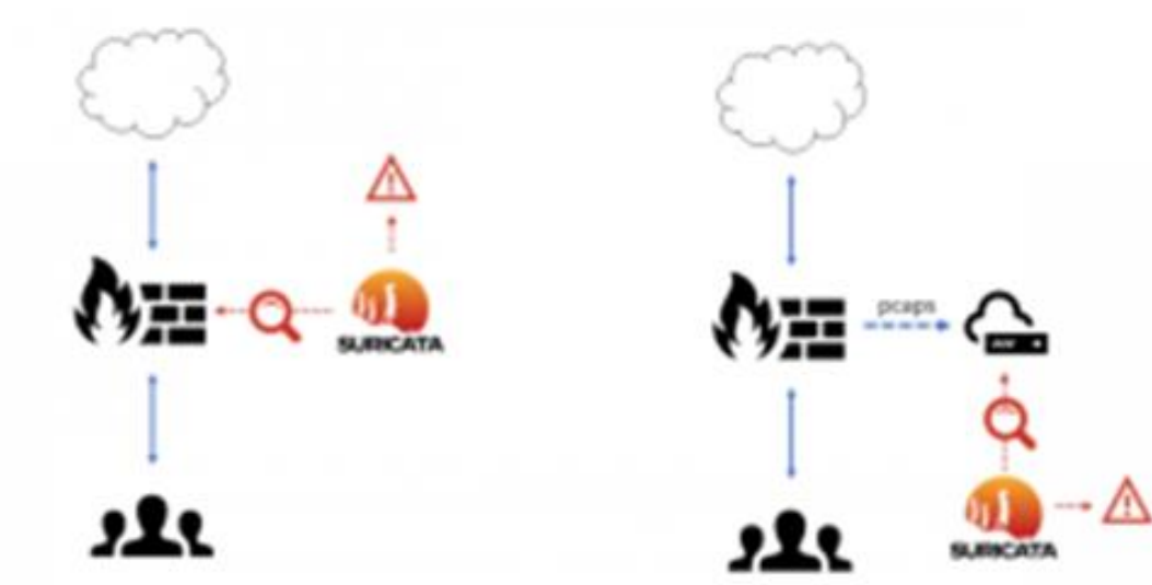
Рисунок 2.1 – Ліворуч: Suricata як моніторинг мережі; праворуч: Suricata як аналізатор пакетів
