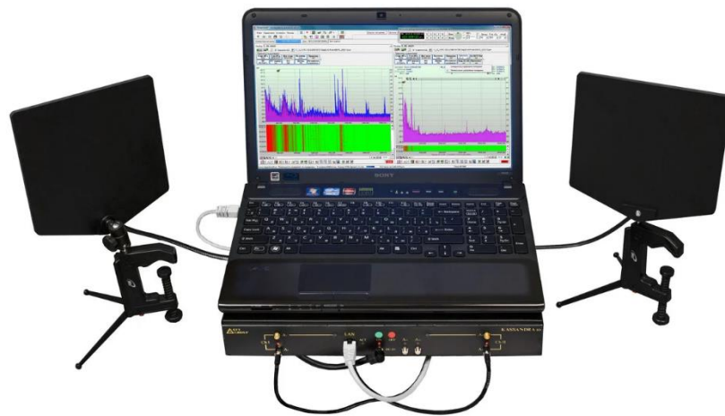
Рис. 1.1. Зовнішній вигляд пошукового АПК Касандра з ПЗ «РадіоІнспекторСофт ТМ»
