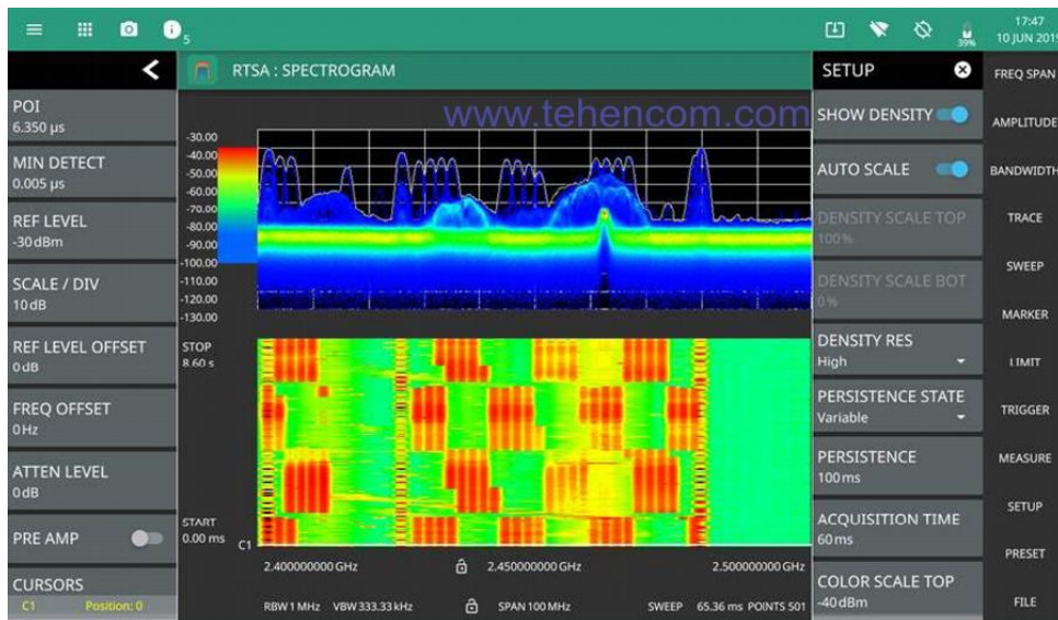
Рис. 3.9. Аналіз спектру в реальному часі за допомогою аналізатора Anritsu MS2090A
