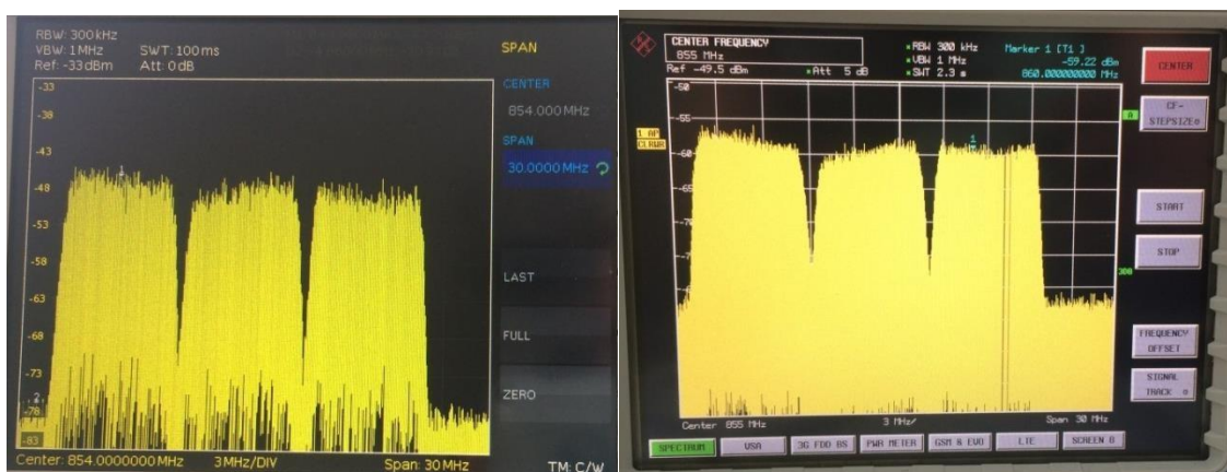
Рис. 3.19 Спектр на вході передавачі та виході приймального тракту трансивера ТГц діапазону
