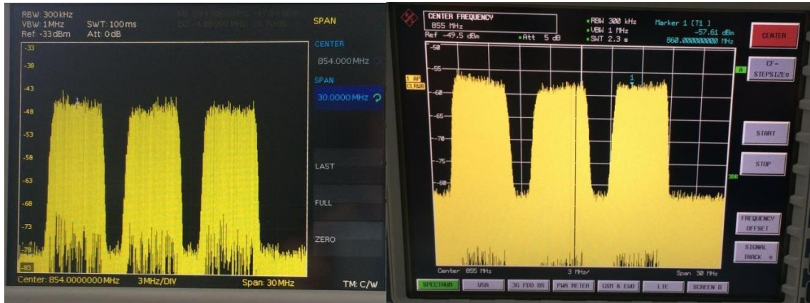
Рис. 3.21 Спектр на вході передачі і виході приймального тракту трансивера ТГц діапазону
