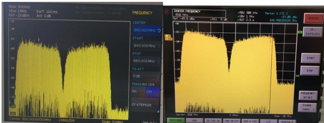
Рис. 3.16 Спектр на вході передачі та виході приймального тракту трансивера ТГц діапазону
