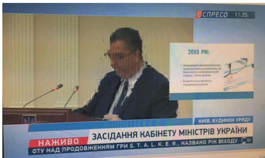
Рис. 3.17 Погіршене зображення телевізійної програми, яка була обрана зі структури транспортного потоку MPEG, що викликано поганою демодуляцією сигналу DVB-S в трансмодуляторі передавальної частини лабораторної установки
