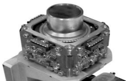
Рис. 2.5 ІЧ-матриця із захисним вікном з германію в оздобленні електронних плат
