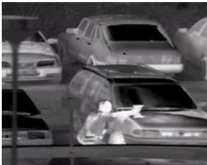
Рис. 1.8 Виявлення за допомогою тепловізора порушника, який сховався за автомобілем
