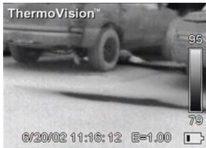
Рис. 1.7 Виявлення за допомогою тепловізора порушника, який сховався під автомобілем
