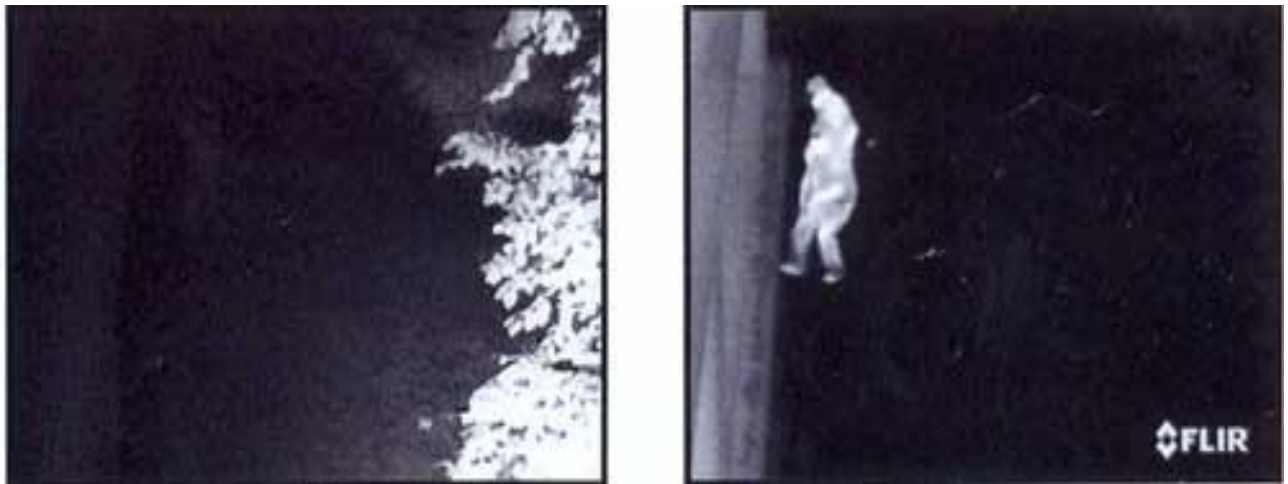
Рис. 2.13 Видиме і тепловізорне зображення при проблемному освітленні
