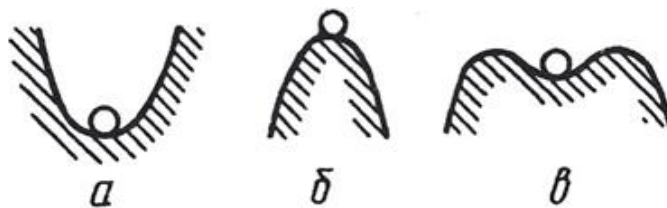
Рис. 3.1. До поняття стійкості рівноваги стану системи куля – поверхня: a – стійкий стан; б – нестійкий стан; в – стан, стійкий при малих і нестійкий при великих відхиленнях
