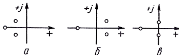
Рис. 3.2. Приклади розташування коренів характеристичного рівняння замкненої системи на комплексній площині: а – стійкої; б – нестійкої; в – яка знаходиться на границі стійкості
